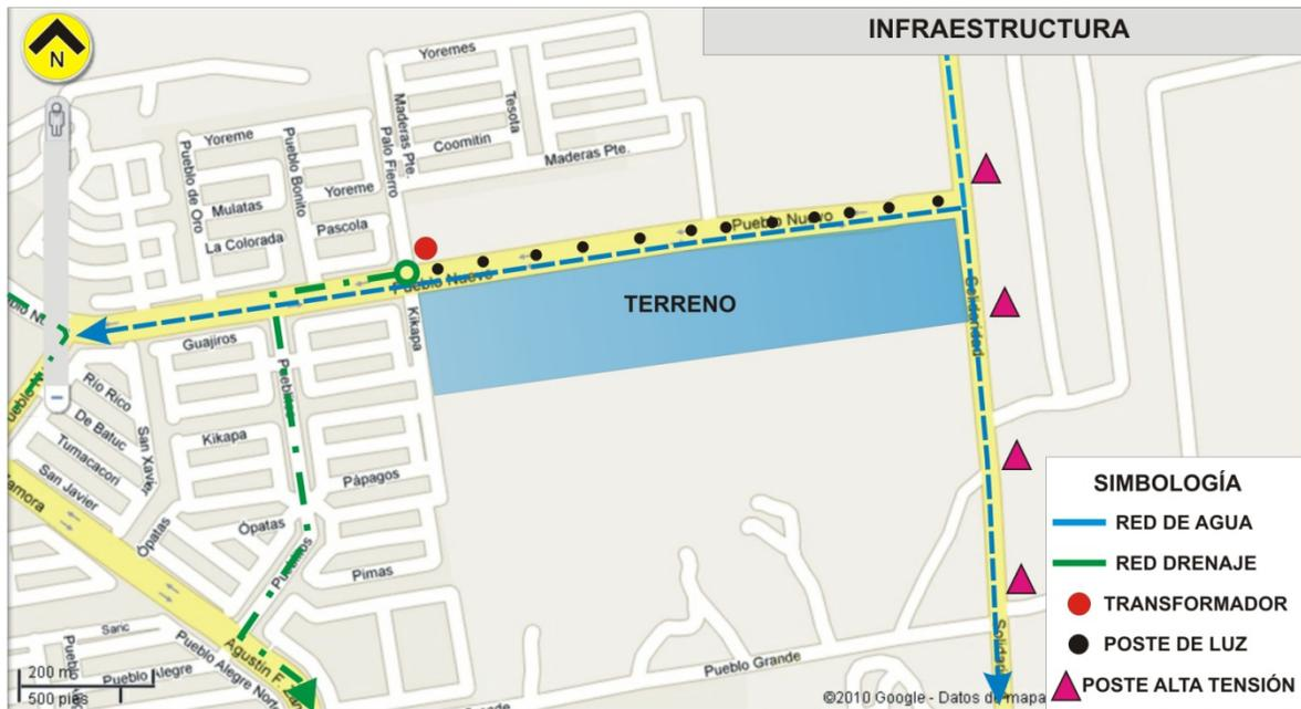
Imagen 1.8 Infraestructura existente en el Predio: Agua, Drenaje, Electricidad y Luz. Fuente: Archivo Propio. S/E.
